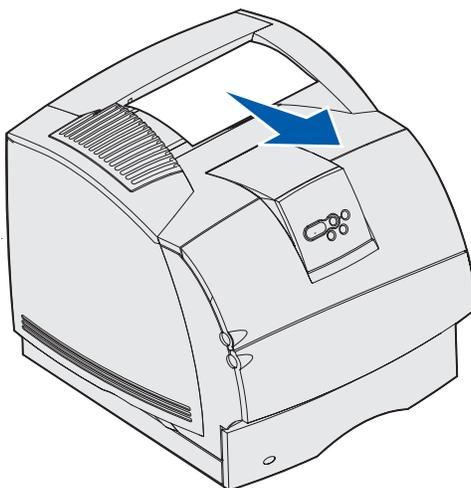
Se il supporto di stampa non si estrae con facilità, interrompere l'operazione. Aprire lo sportello anteriore superiore ed estrarre il supporto di stampa.
